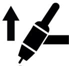
Die LiftArc™-Funktion zündet den Lichtbogen, wenn der Kontakt zwischen der Wolframelektrode und dem Werkstück hergestellt, der Brennerkontakt gedrückt und die Elektrode anschließend wieder vom Werkstück weg angehoben wird. Um die Gefahr einer Wolframverunreinigung bei Arbeitsanfang zu minimieren, ist der Strom am Anfang sehr niedrig und erhöht sich dann bis auf den eingestellten Stromwert. (Dies wird durch die Up-Slope-Funktion gesteuert).
