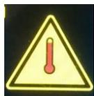
Die Schweißstromquelle verfügt über einen Überhitzungsschutz, der bei zu hoher Innentemperatur ausgelöst wird. In diesem Fall wird der Schweißstrom unterbrochen und auf der Anzeige erscheint ein Überhitzungssymbol. Der Überhitzungsschutz wird automatisch zurückgesetzt, wenn die Temperatur wieder die normale Betriebstemperatur erreicht hat.
