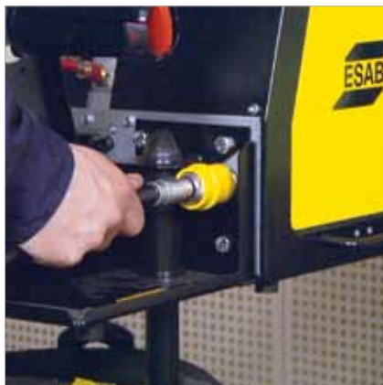
6. lépés. Csatlakoztassa a huzalvezetőt a huzal előtolóhoz.
