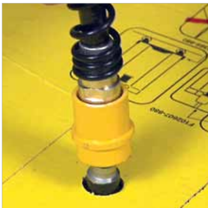
5. lépés. Csatlakoztassa a huzalvezetőt a fedélhez vagy kúphoz a gyorscsatlakozóval.
