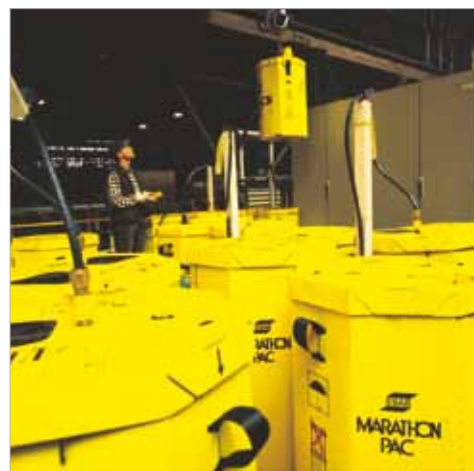
A Marathon Pac™ különleges emelőkerettel egyszerűen emelhető a hegesztőhelyhez.
