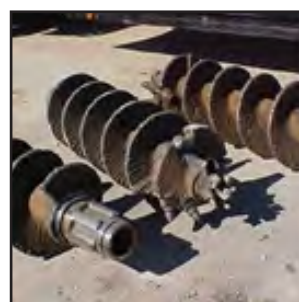
Szállítócsiga javítása Stoody 160 FC-vel
