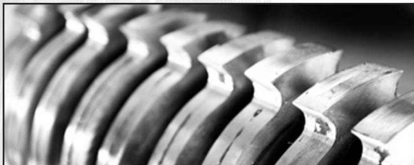
Fémhulladék-újrahasznosító aprító késekhez használt Stoody M7-G
