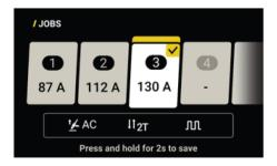
Um die aktuellen Schweißdaten zu speichern, öffnen Sie den Jobs-Bildschirm, um eine verfügbare Jobposition oder eine zu ersetzende Jobposition zu finden. Drücken Sie den Hauptregler und halten Sie ihn zwei Sekunden lang gedrückt.
